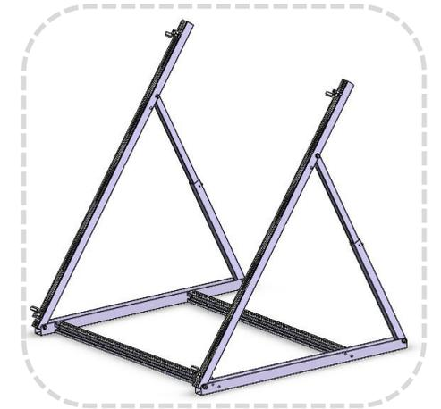
Abb. 7 Fertiger Zusammenbau der verstellbaren Halterung
